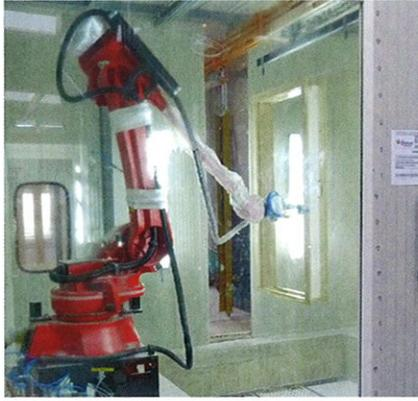
Wasserlacke stellen hohe Ansprüche an das Umfeld der Applikation. Der Lackierroboter arbeitet daher in einer klimatisierten Kabine.
