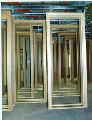
Eine schonende Trocknung bei relativ niedrigen Temperaturen mit entfeuchteter Luft lohnt sich vor allem bei Werkstücken aus Holz.
