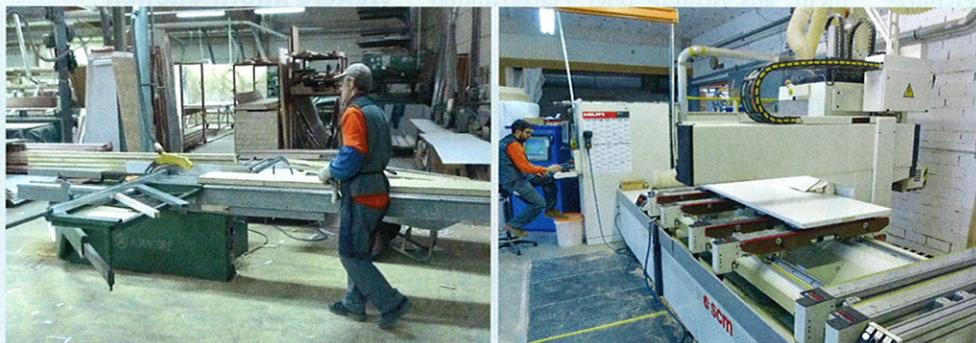
Der Maschinenpark reicht bei Herba von der klassischen Altendorf-Formatkreissäge bis zu zwei modernen Bearbeitungszentren von SCM.
