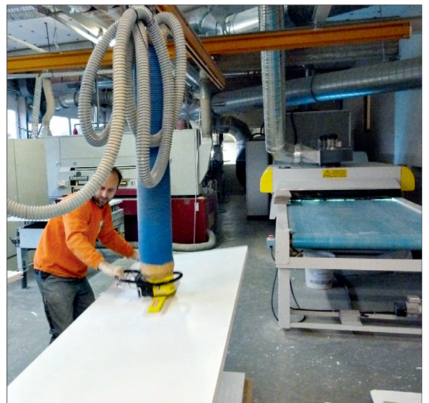
Türblattlackierung: links ist der Einlauf der Lackieranlage für die Türblätter zu erkennen. Nach wenigen Minuten verlassen sie die Anlage durch die Trocknungsanlagen (rechts) in stapelfähigem Zustand. Die Beschichtung findet dabei in einem separaten klimatisierten Bereich (hinter der Wand dieser Halle) statt. Bis zu sechs Mal durchlaufen die Türblätter bei Herba die Lackieranlage.
